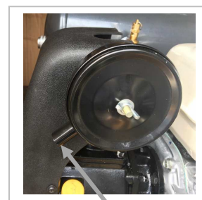
エアフィルタ 吸い込み口(筒状) を左下向きに取付
