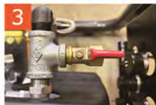
3 シリンダー横の排気バルブの赤いコックを開けます
