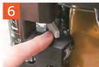
6 エンジンの回転が安定するまで半チョークにします（中間位置まで戻す）
