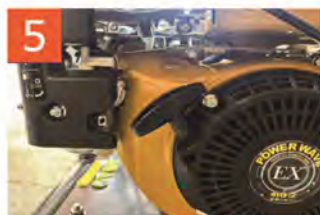
5 リコイルを軽く引っ張り、重みを感じたら強く引きエンジンを始動させます
