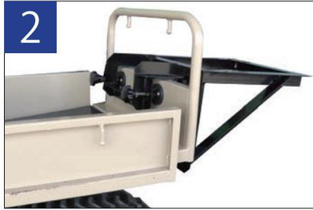
2 運搬車のあおり部に確実に挟み込んでください。ノブを手で締め込み固定してください。
