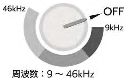
左図の OFF の位置につまみを合わせると、スピーカー出力が OFF になります。OFF の位置から時計回りに回すとスピーカー出力が ON になり高周波を発生します。さらに時計回りに回していくと周波数が高くなっていき、徐々に人間の耳では聞き取れなくなっていきます。
