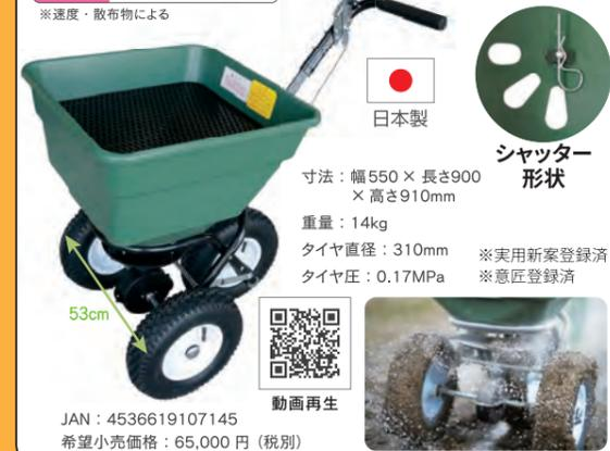
寸法: 幅550×長さ900×高さ910mm 重量: 14kg タイヤ直径: 310mm タイヤ圧: 0.17MPa
