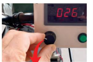
コントロールボックスで回転インペラーを調整 手元のダイヤルで回転インペラーの速度を無段階に調整でき好みの散布幅に調整できます。
